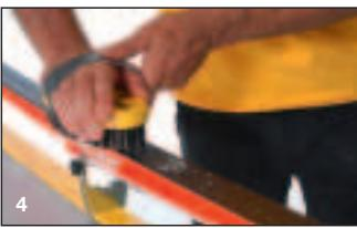
Abb. 4) Belagsstruktur ausbürsten. Belagsstruktur in Laufrichtung mit der Kupferbürste ausbürsten. Für kalte Schneeverhältnisse (härttere Waxe) mit der Nylonbürste nachpolieren. Für das Finish mit der Polierbürste ausbürsten.
