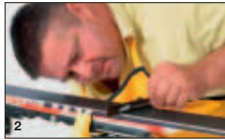
Abb. 2) Kontrolle des Belags mit dem Haarlineal. Prüfen Sie mit dem Haarlineal die Planheit des Belags und bestimmen Sie den Winkel der hängenden Kante.
