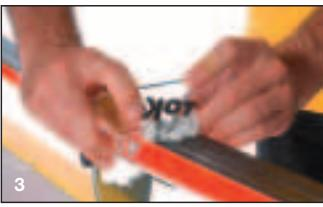
Abb. 3) Wax abziehen. Den Belag nach ca. einer Stunde mit der Plexi Blade in Laufrichtung abziehen.
