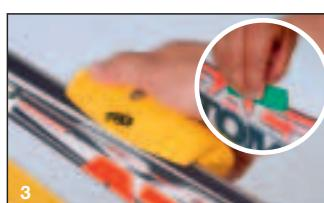
Abb. 3) Grate entfernen. Beim Feilen entstehen Grate. Diese werden mit den Diamantfeilen rot oder grün entfernt. In Wasser eingetaucht, lassen sich die Diamantfeilen leichter über die Kante ziehen (Reibungsverminderung).
