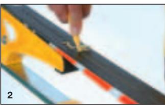
Abb. 1) Wax einbügeln. Das Waxiron mit gleichmässigem Vorschub über die Gleitfläche stossen oder ziehen. Falls das Waxiron nicht leicht gleitet, nochmals etwas Wax auftropfen.
