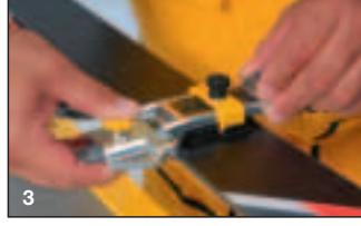
Abb. 3) Kante mit dem Multi Base File Control abhängen. Sollte der Ski zu wenig hängend gefeilt sein (Ski dreht schlecht oder schwer), wird er belagsseitig mit dem Multi Base File Control auf 0,5° oder 1,0° hängend gefeilt. Kontrolle mit dem Prisma-Haarlineal.
